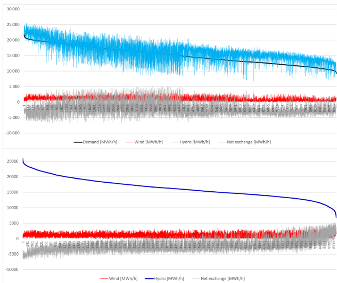
Fig. 4: Vindkraftens effekt i strømforsyningen i vindkraftens toppår 2020 (data er hentet fra NVE og Statnett, og er kalkulert av undertegnede).
