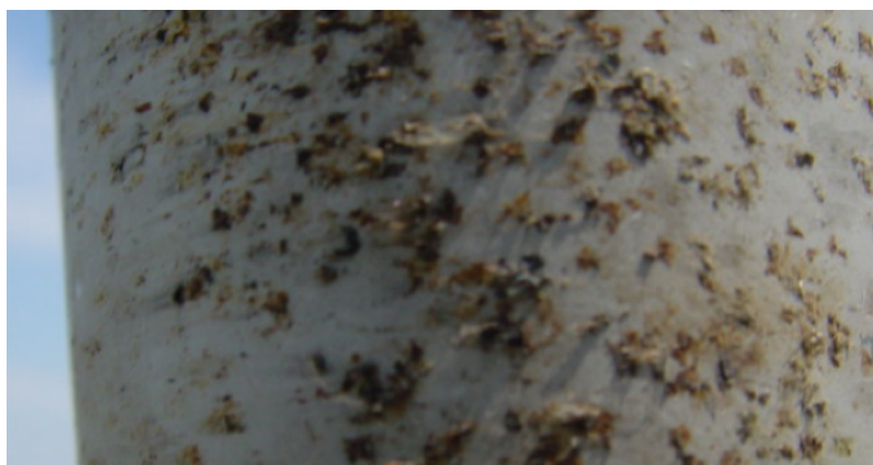
Fig. 3: Massedrap av insekter fører til at turbinens virkningsgrad går ned.
